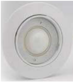
Foto: Sensor colocado en carcasa de un halógeno
