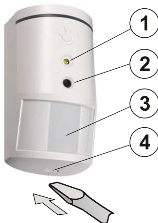
Figura: 1 - flash de cámara para iluminación adicional; 2 - objetivo de cámara; 3 - lente PIR del detector; 4 - cerrojo de la tapa;
