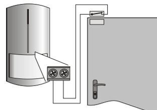
La longitud del cable de conexión a los bornes no debería exceder los 3 m. Se recomienda utilizar un cable blindado. Si la entrada no se utiliza, los bornes deben estar conectados.
