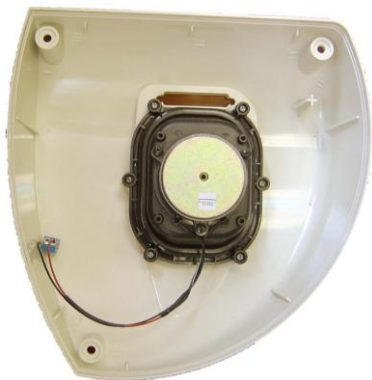
Figura 1: Cubierta con Altavoz
